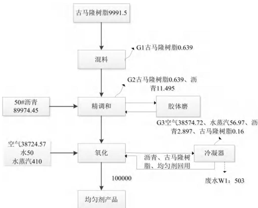
图 3.6.2-3 均匀剂物料平衡图 单位：t/a
